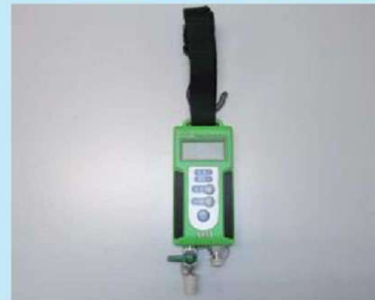
電気式ダイヤフラム式自記圧力計
